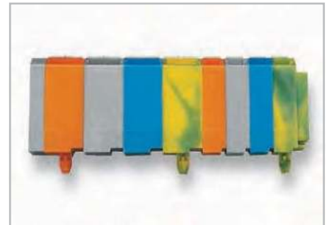
Klemmenleiste mit Rastfüßen, für Blechdicke 0,6 ... 1,2 mm, Befestigungslöcher Ø 3,5 mm
